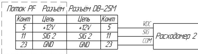
Рисунок А.5 - Схема подключения расходомера №2.
