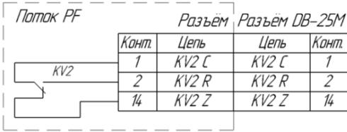
Рисунок А.1 – Схема подключения коммутационного реле 2.
