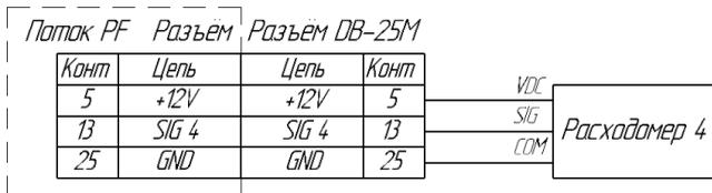
Рисунок А.7 - Схема подключения расходомера №4.
