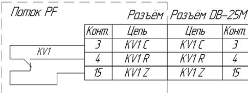
Рисунок А.2 – Схема подключения коммутационного реле 1 (актуальна в устройствах начиная с серийного номера 6 и далее).
