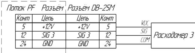
Рисунок А.6 - Схема подключения расходомера №3.
