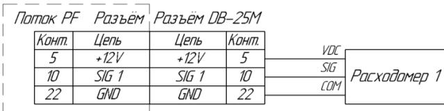
Рисунок А.4 – Схема подключения расходомера №1.
